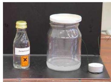
In dem verschlossenen Glas fangen wir ein weiteres farbloses gasförmiges Verbrennungsprodukt auf. Nachdem die Kerze entfernt worden ist, schüttelt man das Glas, so dass sich das Kalkwasser mit dem Verbrennungsprodukt verbindet. Die zu beobachtende milchig-weiße Trübung des Kalkwassers ist ein chemischer Nachweis für das Gas Kohlenstoffdioxid, das ebenfalls bei der Verbrennung von Kerzenwachs entsteht.
