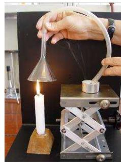
Kohlenstoffdioxid erstickt die Teelichtflamme. Aufgrund dieser Eigenschaft wird Kohlenstoffdioxid auch in einigen Feuerlöschern verwendet.
