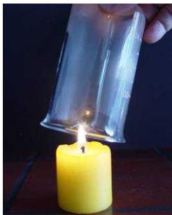
Schaut man sich die Bechergläser nun einmal etwas genauer an, fällt etwas Interessantes auf: Sie sind innen beschlagen! Bei diesem Beschlag handelt es sich um Wasser. So erstaunlich das klingt, beim Verbrennen von Wachsdämpfen entsteht tatsächlich Wasser in Form von Wasserdampf, der an der kalten Glaswandung kondensiert.
