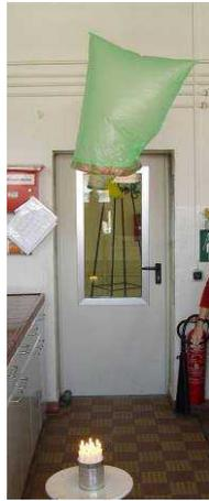
Leider ist der Flug nur ein kurzes Vergnügen, denn infolge der Abkühlung der Luft, landet der Müllbeutel bald wieder unten. Ein echter Heißluftballon müsste also länger schweben. Das kann dadurch erreicht werden, indem die Luft in dem Müllbeutel kontinuierlich weiter erwärmt wird - wie bei einem richtigen Heißluftballon.
