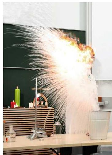
Durch das plötzliche Abkühlen mit Wasser zerspringt das Glas, Wasser kommt in Kontakt mit dem sehr heißen Wachs, verdampft sehr schnell und schleudert das Wachs heraus. Die vielen kleinen Wachströpfchen entzünden sich an der Luft, die Verbrennung gleicht einem Flammenwerfer.
