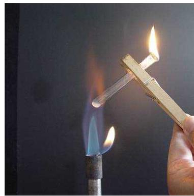
Offensichtlich muss Wachs so stark erhitzt werden, bis sich Wachsdampf bildet, der sich an der Reagenzglasöffnung entzünden lässt. Die Flamme besteht also aus brennenden Dämpfen!
