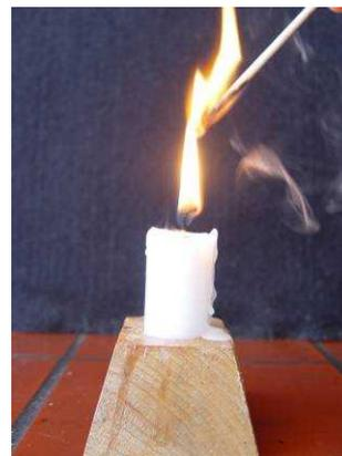
Eine Kerze wird ausgepustet. In den aufsteigenden Dampf wird ein brennender Span gehalten. Die heißen Dämpfe entzünden sich wieder, die Flamme „springt“ zum Docht herunter und entzündet diesen.
